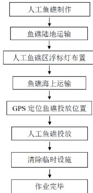
图 2.3-1 人工鱼礁制作及投放流程
